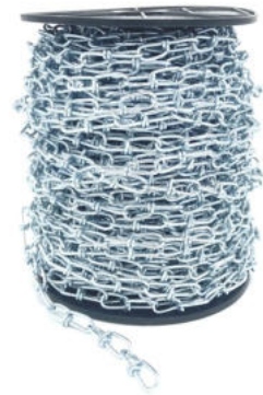
Knotenkette - K14 1,4 mm ø Stahl-verzinkt Innenlänge: 21 mm Außenbreite: 7 mm Art-Nr. 06-104001-01 Verpackungseinheit: 30 m Rolle
