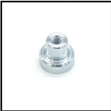
Flachgreifer aus Neodym-Eisen-Bor, verzinkt mit Gewindebuchse M3 20 mm Ø, 4,5 mm hoch, Haftkraft: 2,5 kg Art-Nr. 03-610010-01
