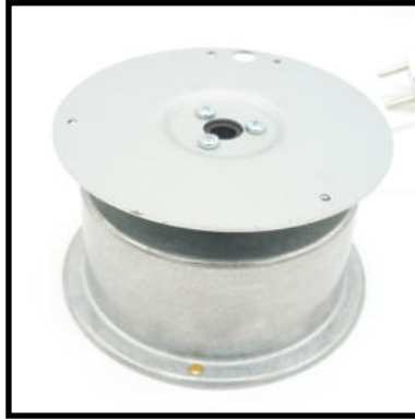
Drehbühne 10 kg Tragkraft Zinkgehäuse, Drehteller: 124 mm \varnothing Gehäusedurchmesser: 130 mm Gesamthöhe: 72 mm Drehzahl: 2,5 U/Min. (rechtsdrehend) Betriebsspannung: 220 - 240 V Art-Nr. 05-009225-08 111,00 € per Stück
