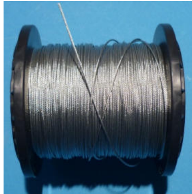
Stahldrahtseil 1,25 mm ø , verzinkt Konstruktion: 6x7 - WSC (7x7) Seilfestigkeitsklasse: 1770 N/mm 2 DIN EN 12385-4 Art-Nr. 01-601125-01 Verpackungseinheit: 100 m Rolle 35,70 € per Rolle
