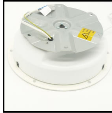
Drehbühne 20 kg Tragkraft weißes Kunststoffgehäuse, mit Flanschteller 225 mm \varnothing x 2,5 mm Gehäusedurchmesser: 272 mm Gesamthöhe: 101 mm Drehzahl: 2,5 U/Min. (rechtsdrehend) Betriebsspannung: 220 - 240 V mit Schleifkontakt für Stromübertragung max. 4 Ampere (bis 900 Watt) Art-Nr. 05-025001-08 293,50 € per Stück
