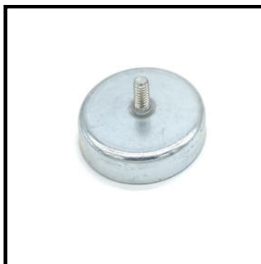
Flachgreifer aus Hartferrit, verzinkt mit Gewindezapfen M4 x 8 mm 32 mm Ø, 7 mm hoch, Haftkraft: 8 kg Art-Nr. 03-200032-01 2,69 € per Stück
