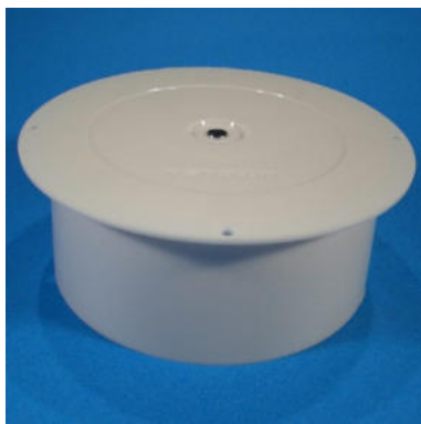
Batteriedrehbühne 4 kg Tragkraft ohne Bodenplatte offener Zugang zum Batteriehalter, weißes Kunststoffgehäu- se, Betrieb mit 1 bzw. 2 Monozellen R20 R1,5V Gehäusedurchmesser: 150 mm Gesamthöhe: 58 mm Drehzahl: 1,7 U/Min. (rechtsdrehend) Art-Nr. 05-035000-08 28,20 € per Stück
