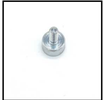
Flachgreifer aus Neodym-Eisen-Bor, verzinkt mit Gewindezapfen M4 x 8 mm 10 mm \varnothing , 4,5 mm hoch, Haftkraft: 2,5 kg Art-Nr. 03-650010-01 2,36 € per Stück
