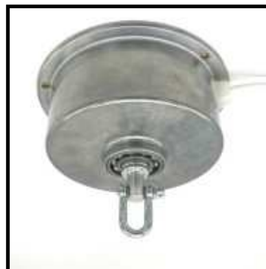
Hängedrehbühne 20 kg Tragkraft zur Deckenbefestigung, Hängeachse mit Schäkkel, verzinktes Gehäuse, Gehäusedurchmesser: 130 mm Gesamthöhe: 107 mm (inkl. Schäkkel) Drehzahl: 2,5 U/Min. (linksdrehend) Betriebsspannung: 220 - 240 V Art-Nr. 05-200101-08 158,90 € per Stück Art-Nr. 05-200102-08 mit Schleifkontakt für Stromübertragung max. 4 Ampere (bis 900 Watt) 214,60 € per Stück
